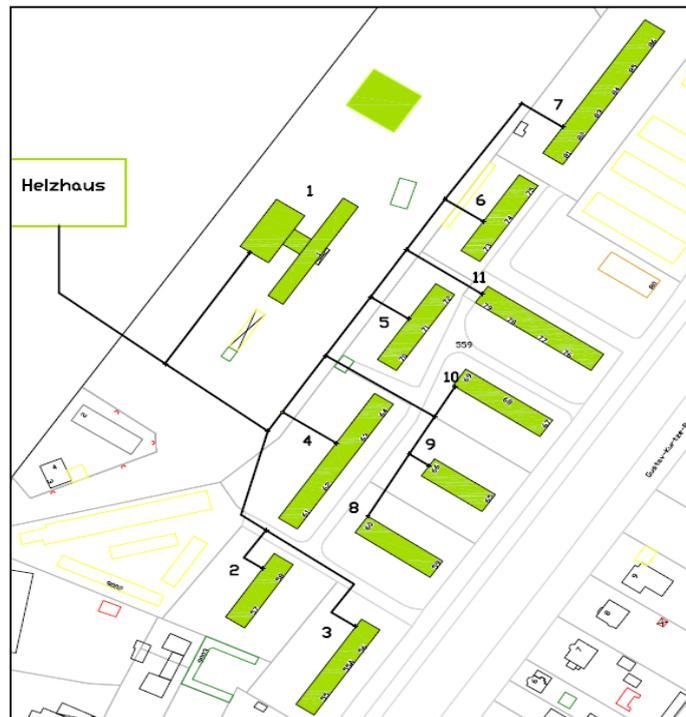
Nahwärmeinsel Neue Mühle: Anschluss von 14 Wohngebäuden mit einem Gesamtwärmebedarf von 1.300 MWh und rund 700 kW Leistungsbedarf (eine Heizstation, rund 600 m Nahwärmeleitung, 14 Hausanschlussstationen).
